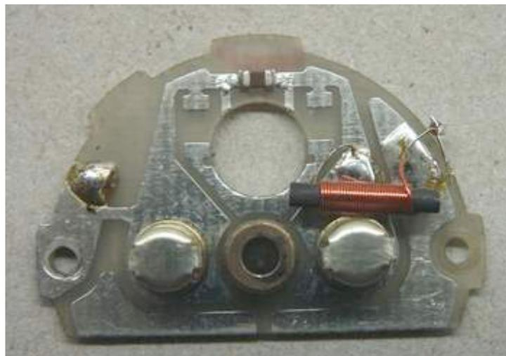
**Motorschild, bei dem durch Auftrennen einer Brücke die Masseverbindung getrennt wird (504720)**
