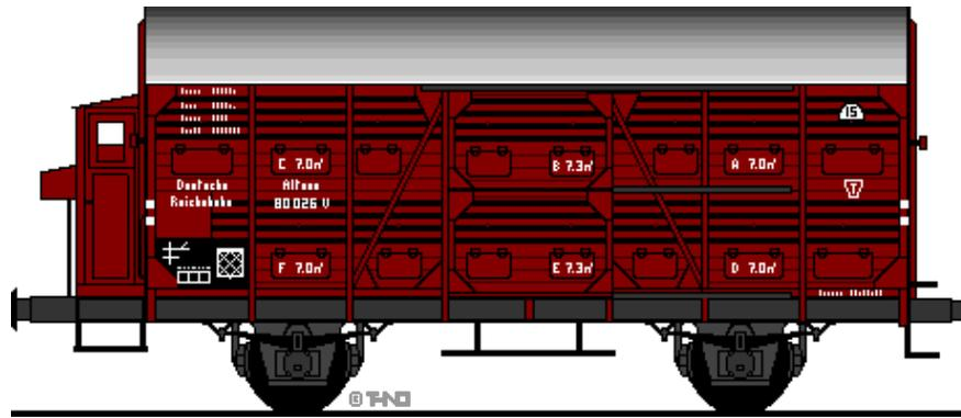
Basierend auf der Konstruktion des gedeckten Güterwagens der Austauschbauart, von dem das Fahrgestell vollständig und das Gerippe des Wagenkastens fast unverändert übernommen wurde, ist auch ein Kleinviehverschlagwagen gebaut worden. Zur Vergrößerung der nutzbaren Ladefläche ist lediglich ein Zwischenboden eingezogen worden. Fahrzeuge mit dem Gattungszeichen Vp dürfen auch zum Transport von Obst und Gemüse verwendet werden.
