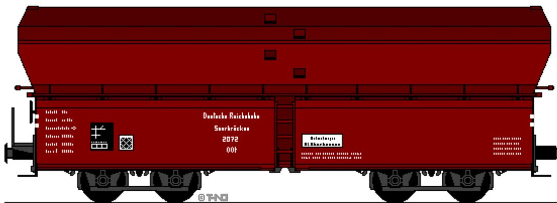
Von dem offenen Kokswagen unterschied sich der geschlossene Kokswagen durch einen Verschluss des Laderaumes mittels 12 Klappdeckeln.
