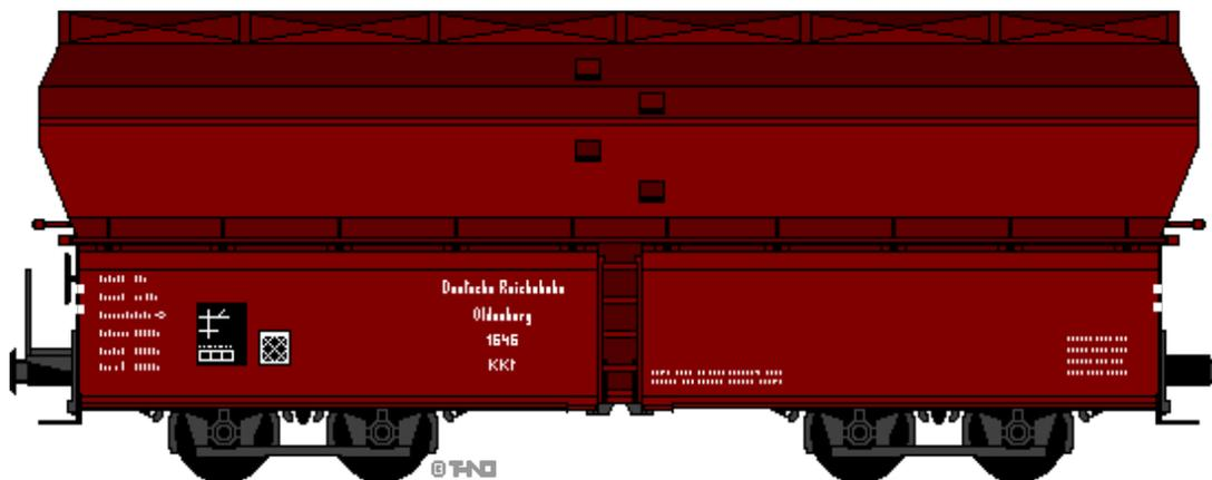
Auf der Basis des Kohlewagens wurde auch ein geschlossener Kaliwagen mit gleichen Abmessungen für den Transport von Kali- und Steinsalz gebaut, der als Privatwagen von Bergwerken und Chemiebetrieben zum Einsatz kam.
