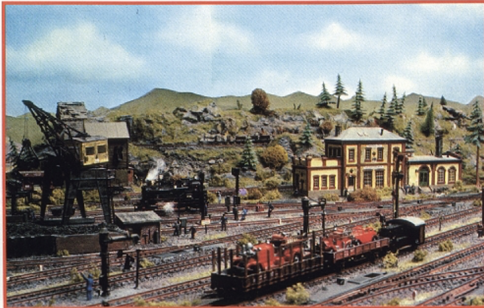
13. Op de juiste wijze ingebed en geschilderd, doen de kunststof rails van MÄRKLIN het bestlist goed. Enige wisselaandrijvingen konden helaas niet „ondergronds” worden aangebracht.
