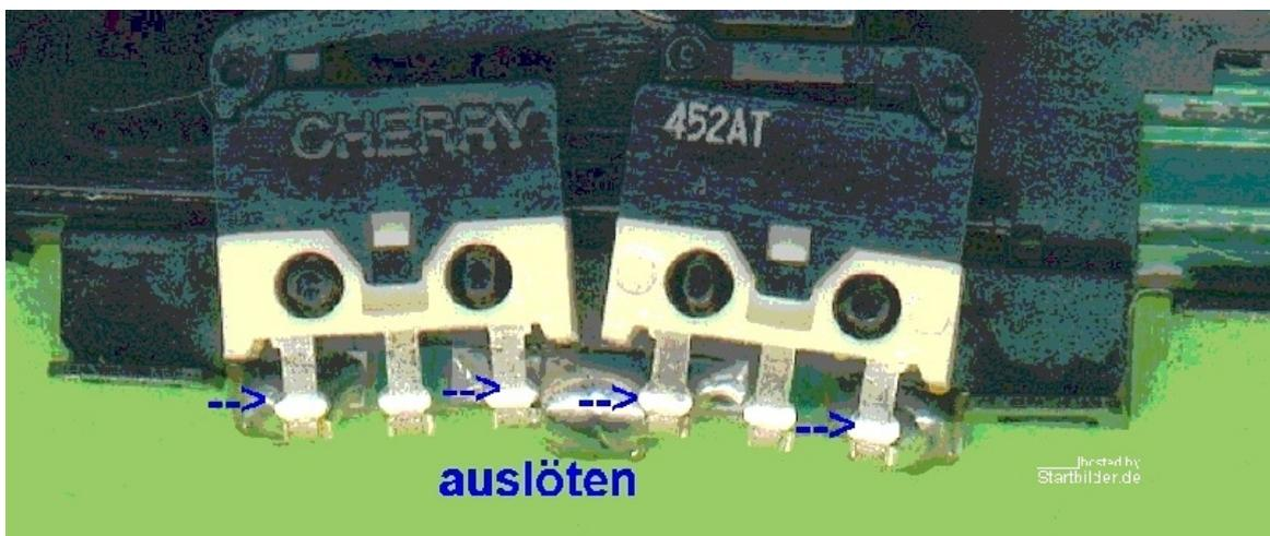
Von jedem Mikroschalter wird jeweils der außen anliegende Anschluss von der Platine ausgelötet
